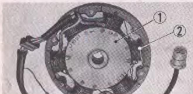
① A.C. generator rotor ② A.C. generator stator
