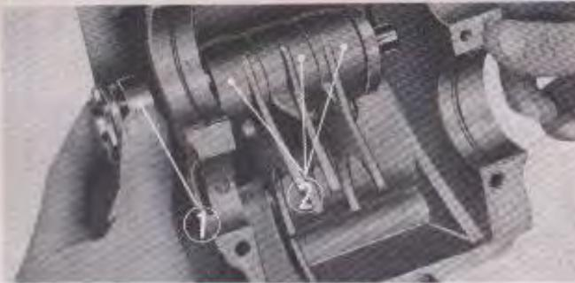
① Gear shift drum ② Gear shift forks
